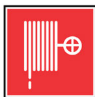
Agulheta de incêndio
